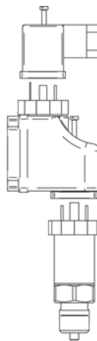
ИК 4-20М, монтаж в линию связи
